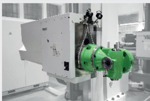
Универсальная фрезерная головка UFR40-100 позволяет фрезеровать или сверлить в любой наклонной плоскости.
