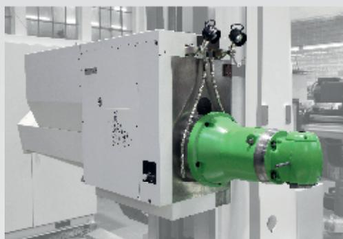
Фрезерная головка FR40-10 позволяет фрезеровать как на базовых, так и наклонных плоскостях параллельно оси шпинделя или сверлить в базовых плоскостях, перпендикулярных оси шпинделя.
