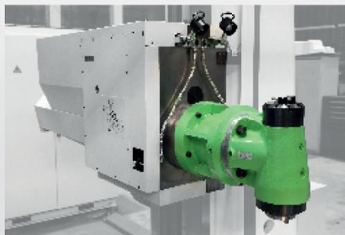
Фрезерная головка HPR-50 позволяет фрезеровать как на базовых, так и наклонных плоскостях параллельно оси шпинделя или сверлить в базовых плоскостях, перпендикулярных оси шпинделя.
