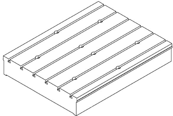
Durch die Kombination mehrerer Spannplatten nebeneinander kann ein großes Aufspannfeld gebildet werden. Das Aufspannfeld kann nur durch Spannplatten desselben Typs gebildet werden.
