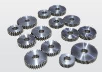
Der Satz RZ100 ermöglicht das Schneiden von 47 weiteren metrischen und Whitworth-Zoll-Gewinden, die man mit der Standardkinematik zum Schalten der 18 Grundgewindeschneide-Vorschübe (Gänge) der Maschine nicht herstellen kann.
