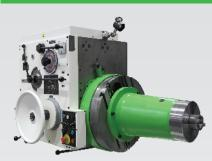
Die Führungsstütze erhöht deutlich die Steifigkeit des Lagers der Arbeitsspindel der Maschine und ermöglicht dadurch den Einsatz insbesondere für ein Kraft- bzw. Präzisionszerspanen bei größeren Ausladungen und das im gesamten Drehzahlbereich, wobei gleichzeitig ein Ausfahren der Arbeitsspindel möglich ist.
