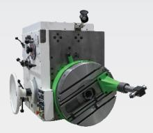
Der Werkzeugteleskophalter TD50 ermöglicht bei der Arbeit mit der Planscheibe die Bearbeitung tiefer innerer und äußerer Flächen größeren Durchmessers.
